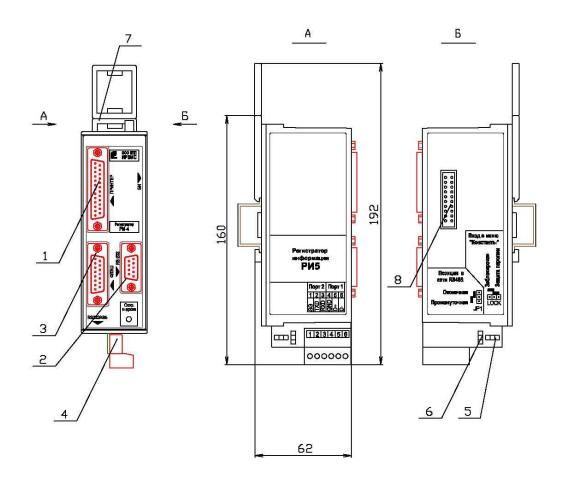
1. Разъем LPT-порта; 2. Разъем для подключения интерфейсного кабеля RS232 к порту 1; 3. Разъем для подключения флэш-носителя; 4. Контактная система для подключения интерфейсных кабелей RS232 к порту 2 и RS485 к порту 1; 5. Штеккеры для установки перемычки блокировки меню "Константы"; 6. Штеккеры для установки резистора-терминатора в сети RS485; 7. Защелка; 8. Разъем для подключения БИ.
