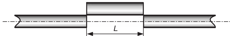
Рисунок 2.4 – Схема врезки в трубопровод при установке расходомера
