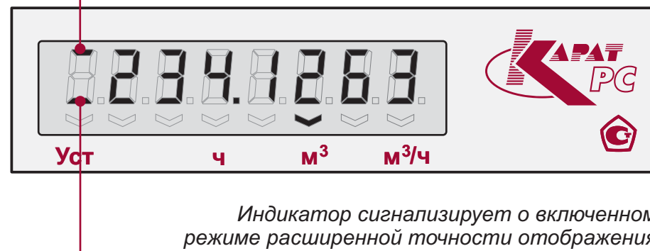
Рисунок 1.12 – Отображение накопленного прямого объема в режиме расширенной точности
