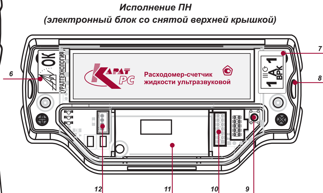
Рисунок 1.6 – Устройство электронного блока
