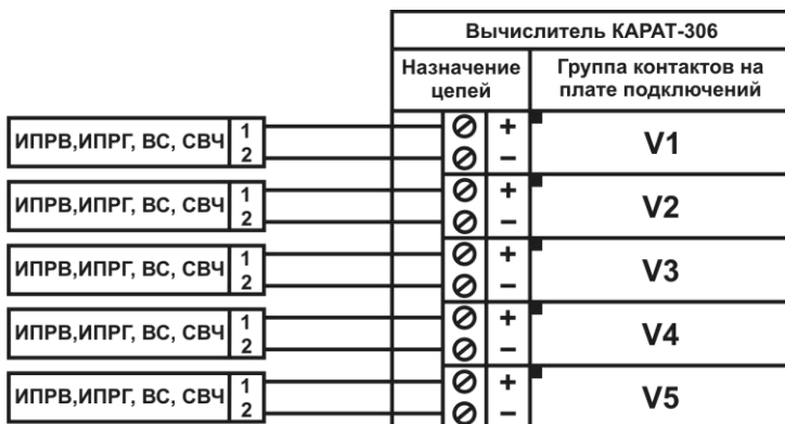
Рисунок 2.6 – Схема подключения ИПРВ, ИПРГ, ВС и СВЧ
