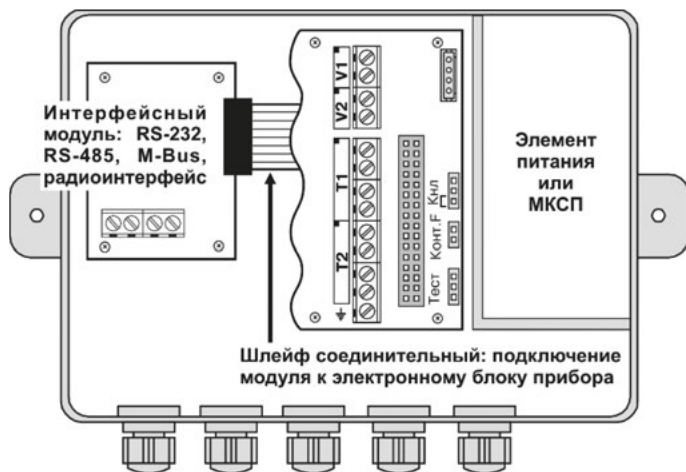
Рисунок Б.4 – Внешний вид монтажного отсека вычислителя KAPAT-306 с установленным интерфейсным модулем
