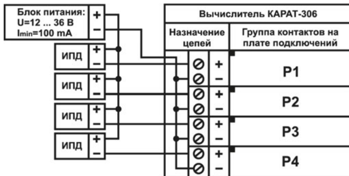
Рисунок В.1 – Схема подключения ИПРВ, ИПРГ, ВС и СВЧ
