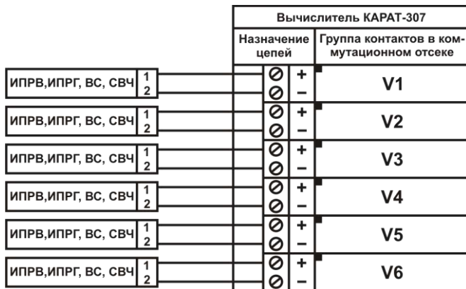
Рисунок 2.5 – Схема подключения ИПРВ, ИПРГ, ВС и СВЧ
