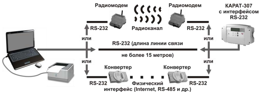
Рисунок В.1 – Принципиальная схема передачи данных по интерфейсу RS-232
