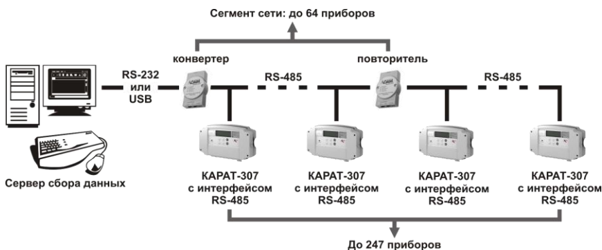
Рисунок В.2 – Принципиальная схема передачи данных по интерфейсу RS-485
