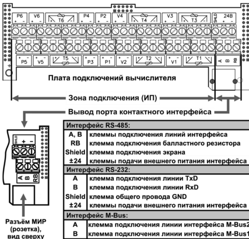
Рисунок 1.7 – Подключение вычислителя к контактным интерфейсам
