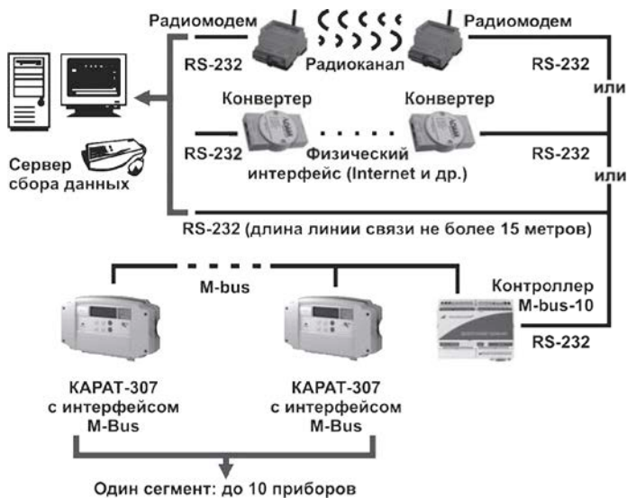
Рисунок В.4 – Принципиальная схема передачи данных по интерфейсу M-Bus при использовании контроллера M-bus-10
