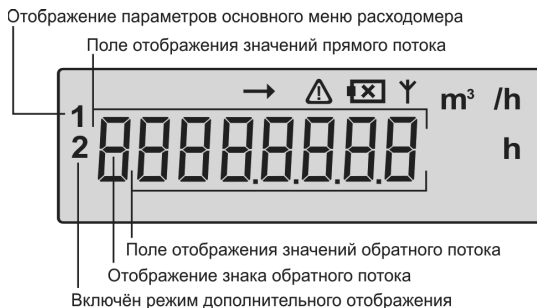
Рисунок 7 – Информационное поле прибора, все цифры и знаки включены
