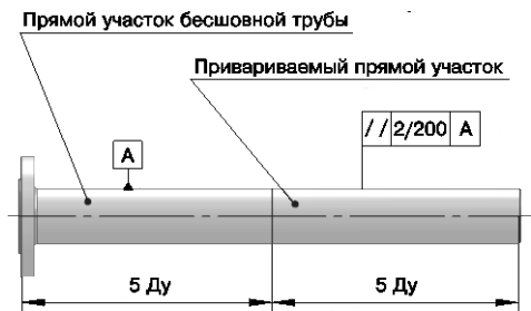
Рисунок 2.6 – Требования к геометрии сварного прямого участка
