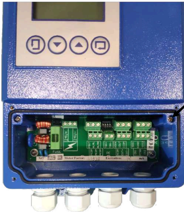
Рисунок 18. Схема пломбировки ВП МТ101
