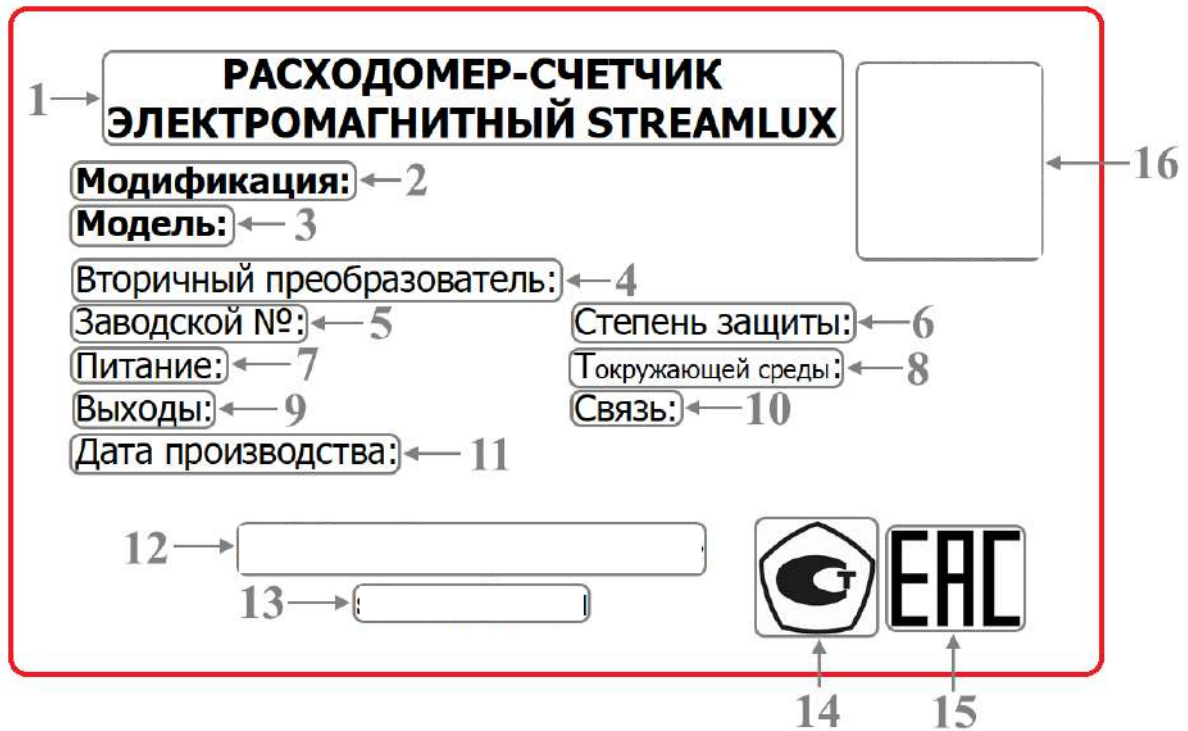
Рисунок 16. Маркировочная табличка вторичного преобразователя
