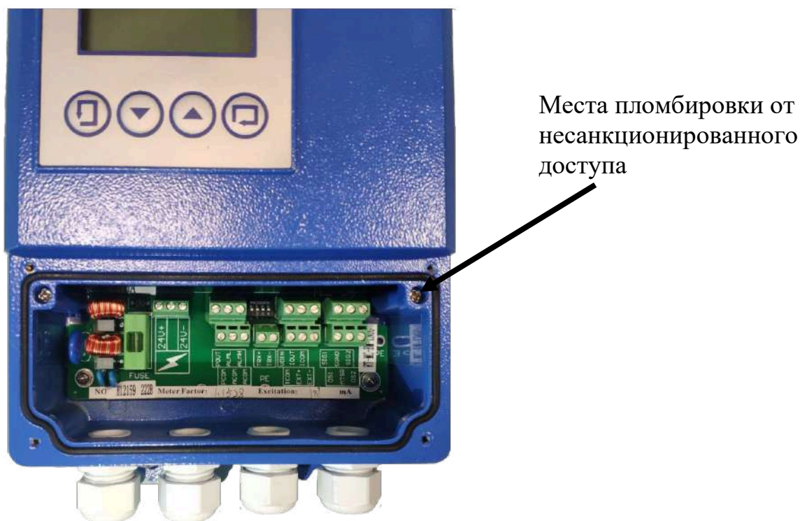
Рисунок 9. Схема пломбировки вторичного преобразователя
