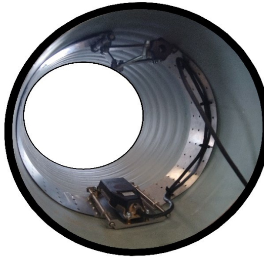
Рисунок 4.7. Расположение зонда на монтажном комплекте внутри трубы с диаметром до 900 мм.
