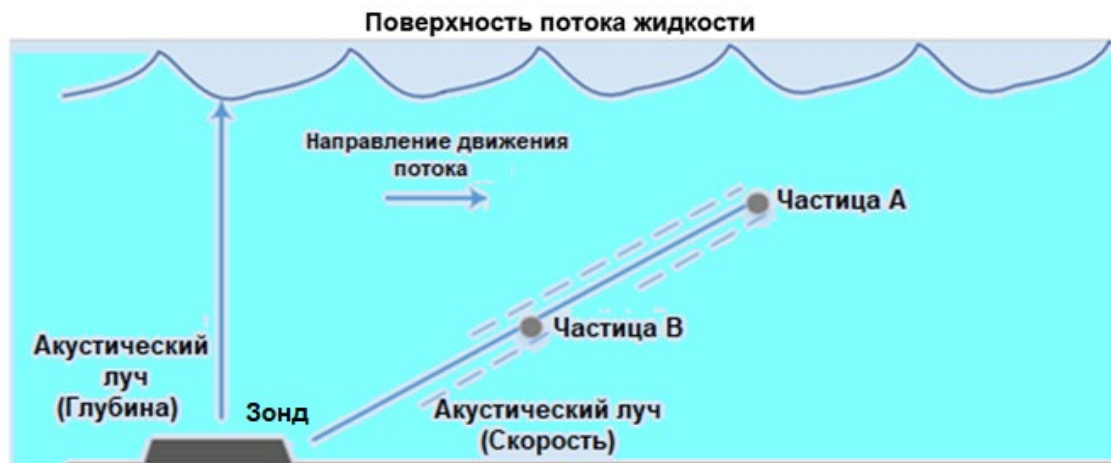
Рисунок 3.1. Пример распространения УЗ сигналов для определения скорости и глубины потока жидкости
