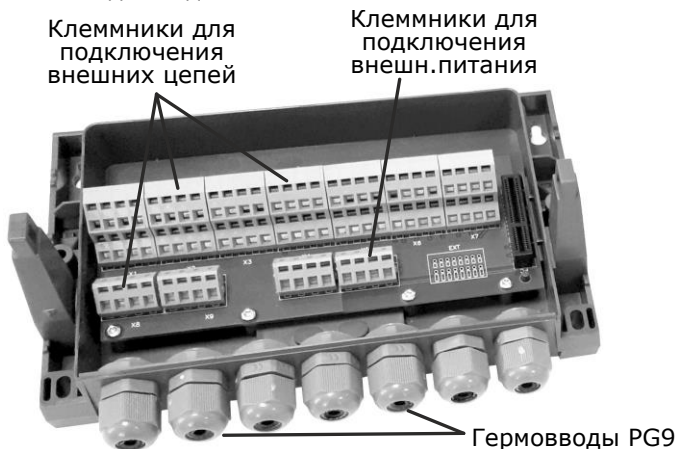
Рис. 2.4 – Вид на монтажный отсек при снятой крышке
