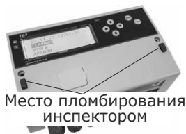
б) Пломба инспектора снабжающей организации
