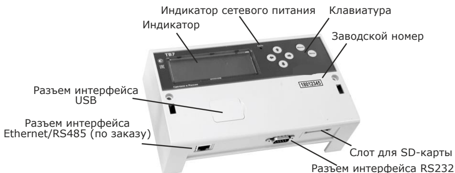
Рис. 2.1 – Внешний вид приборного отсека ТВ7 (вид сверху)
