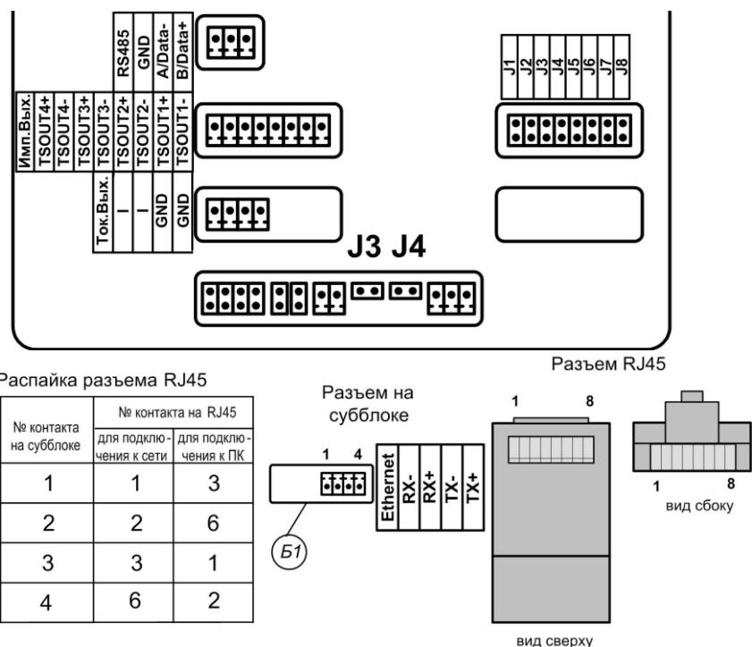
**Рис.А.9. Обозначения коммутационных элементов на субблоке вычислителя.**
