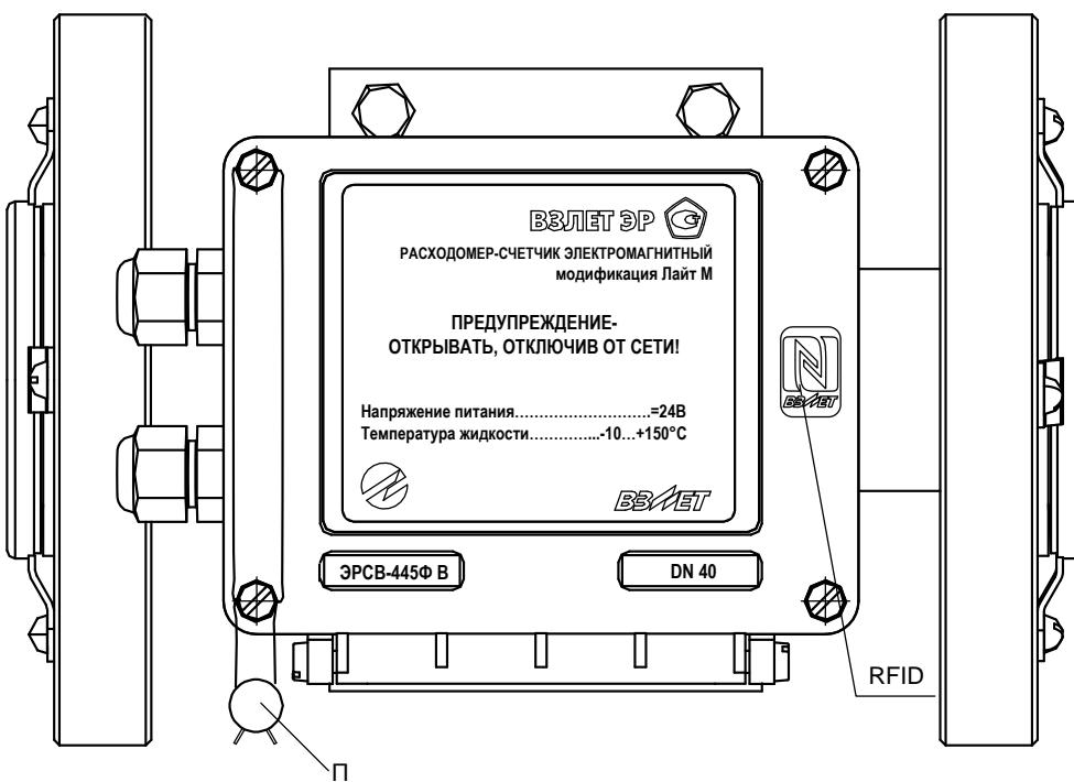
**Рис.Б.8б. Вид сверху измерительного блока расходомера фланцеванного исполнения с металлическим измерительным блоком.**
