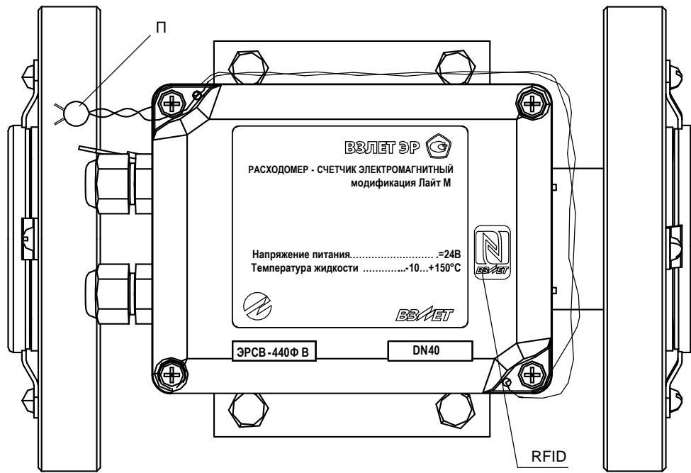
**Рис.Б.8а. Вид сверху измерительного блока расходомера фланцеванного исполнения с пластмассовым измерительным блоком.**
