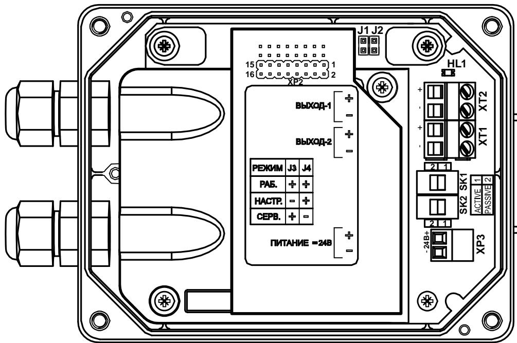
Рис.Б.10. Вид модуля RFID, установленного в измерительный блок.
