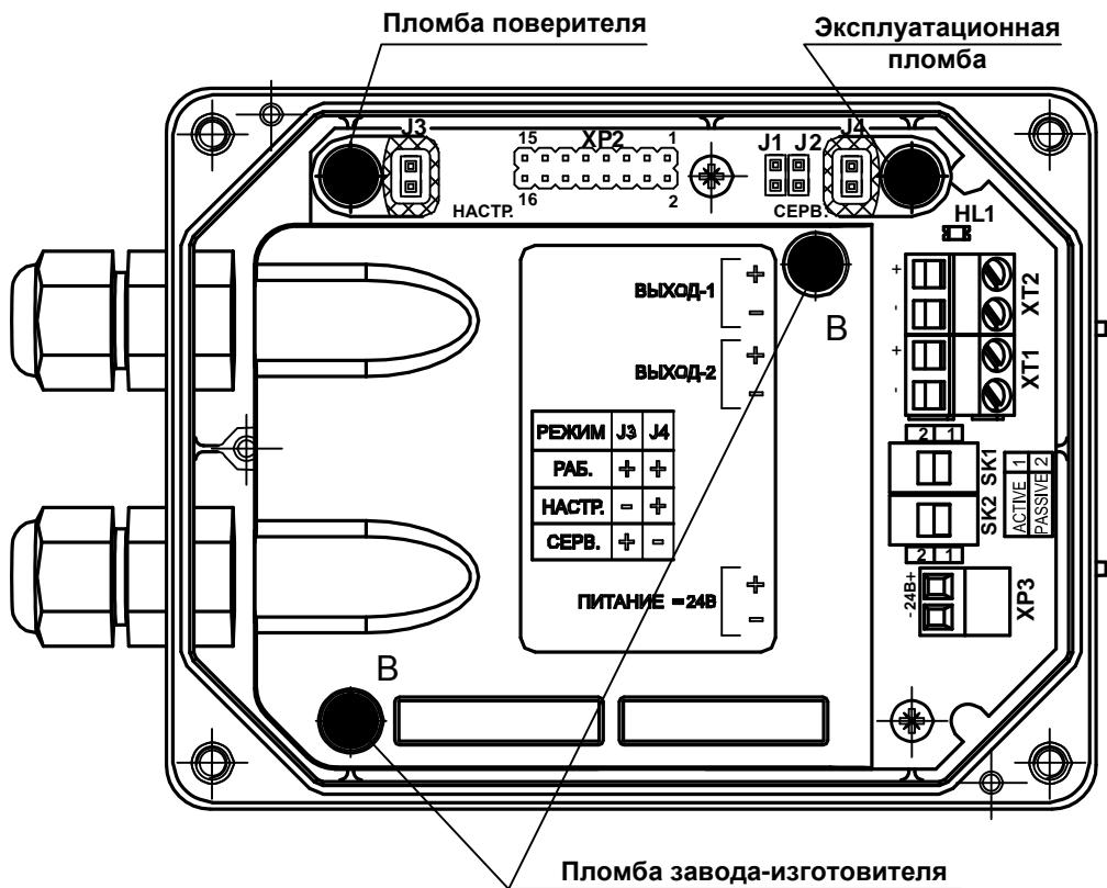
*XP2 – разъем подключения шлейфа модуля интерфейсов или адаптера USB-ЭР;*
