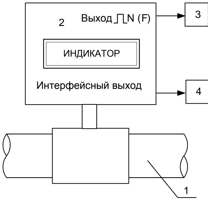
1 – трубопровод поверочной установки; 2 – расходомер; 3 – счетчик импульсов (частотометр); 4 – персональный компьютер.
