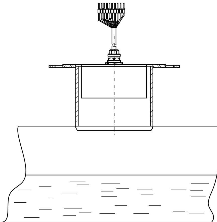
**Рис.А.6. Монтаж АС-111-013 с помощью установочного патрубка.**
