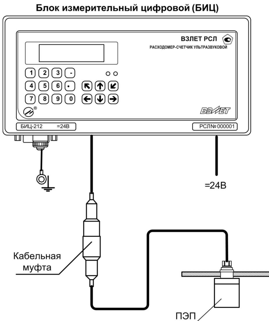
**Рис.Б.5. Структурно-монтажная схема расходомера исполнения РСЛ-222.**
