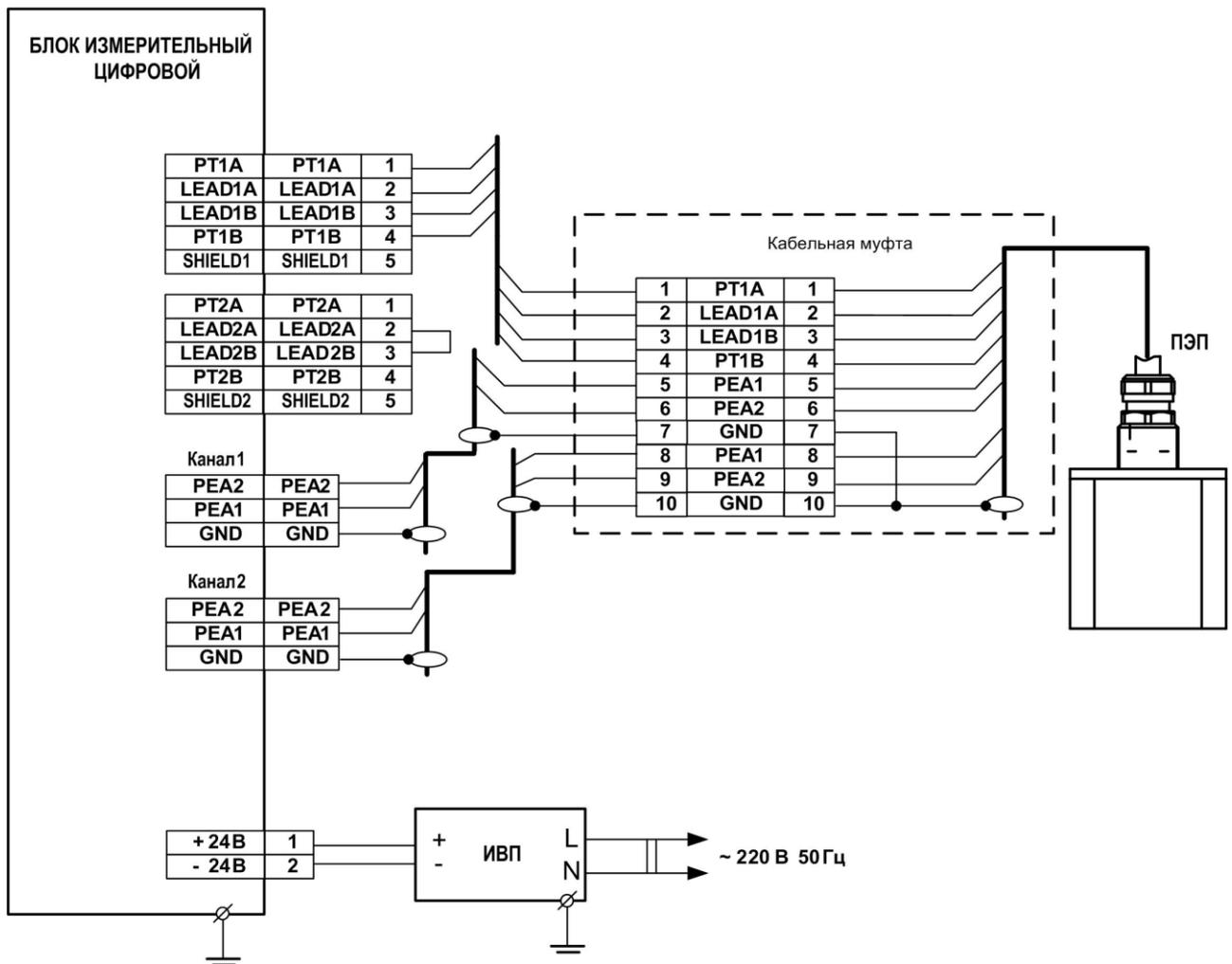
**Рис.Б.2. Схема соединения БИЦ расходомера с АС исполнения АС-111-013.**
