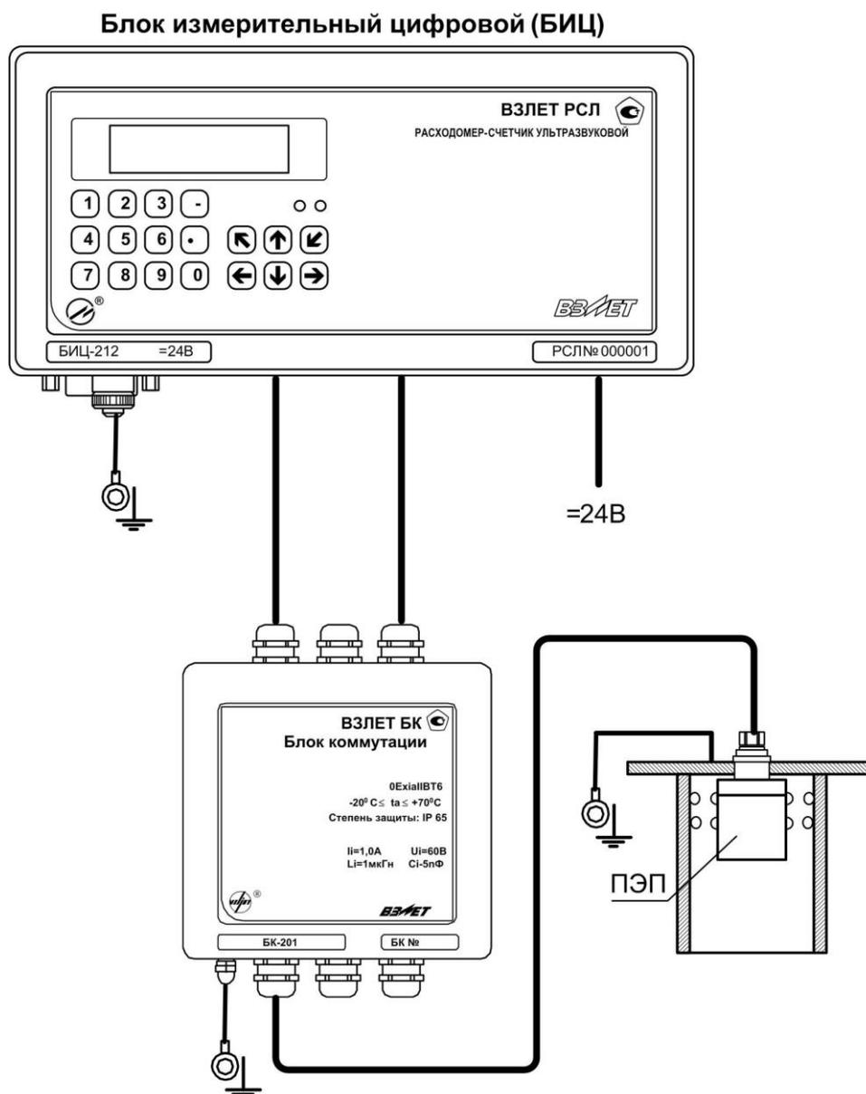
**Рис.Б.4. Структурно-монтажная схема расходомера исполнения РСЛ-212.**
