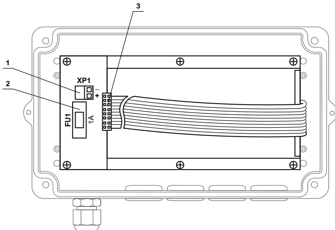
1 – разъем =24 В; 2 – предохранитель расходомера; 3 – шлейф связи с модулем измерителя.
