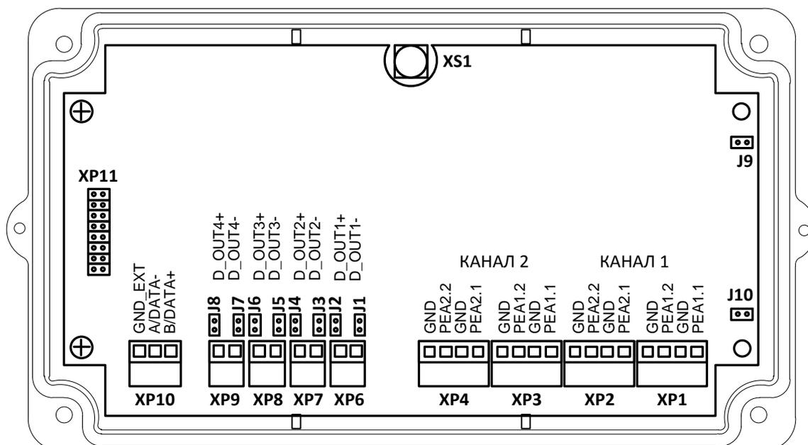
*XS1 – технологический разъем для подключения частотомера при измерении частоты опорного кварца (используется при поверке прибора);*
