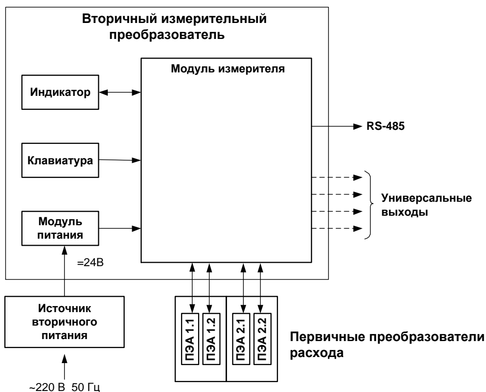
Рис. 4. Структурная схема двухканального расходомера.
