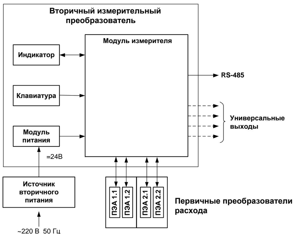
**Рис. 4. Структурная схема двухканального расходомера.**
