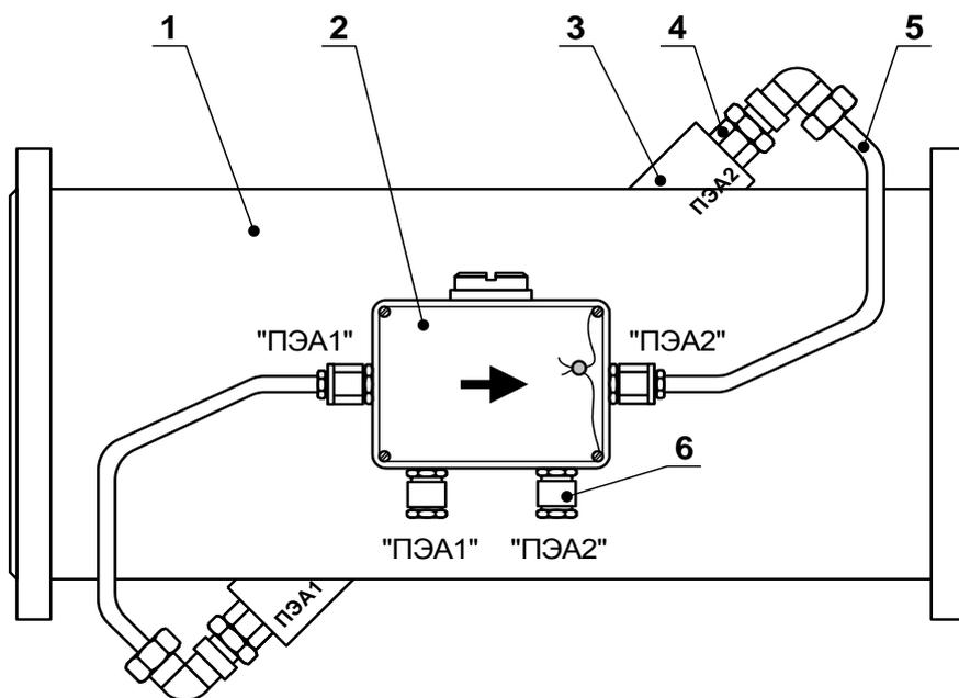
1 – измерительный участок; 2 – устройство коммутационное;
