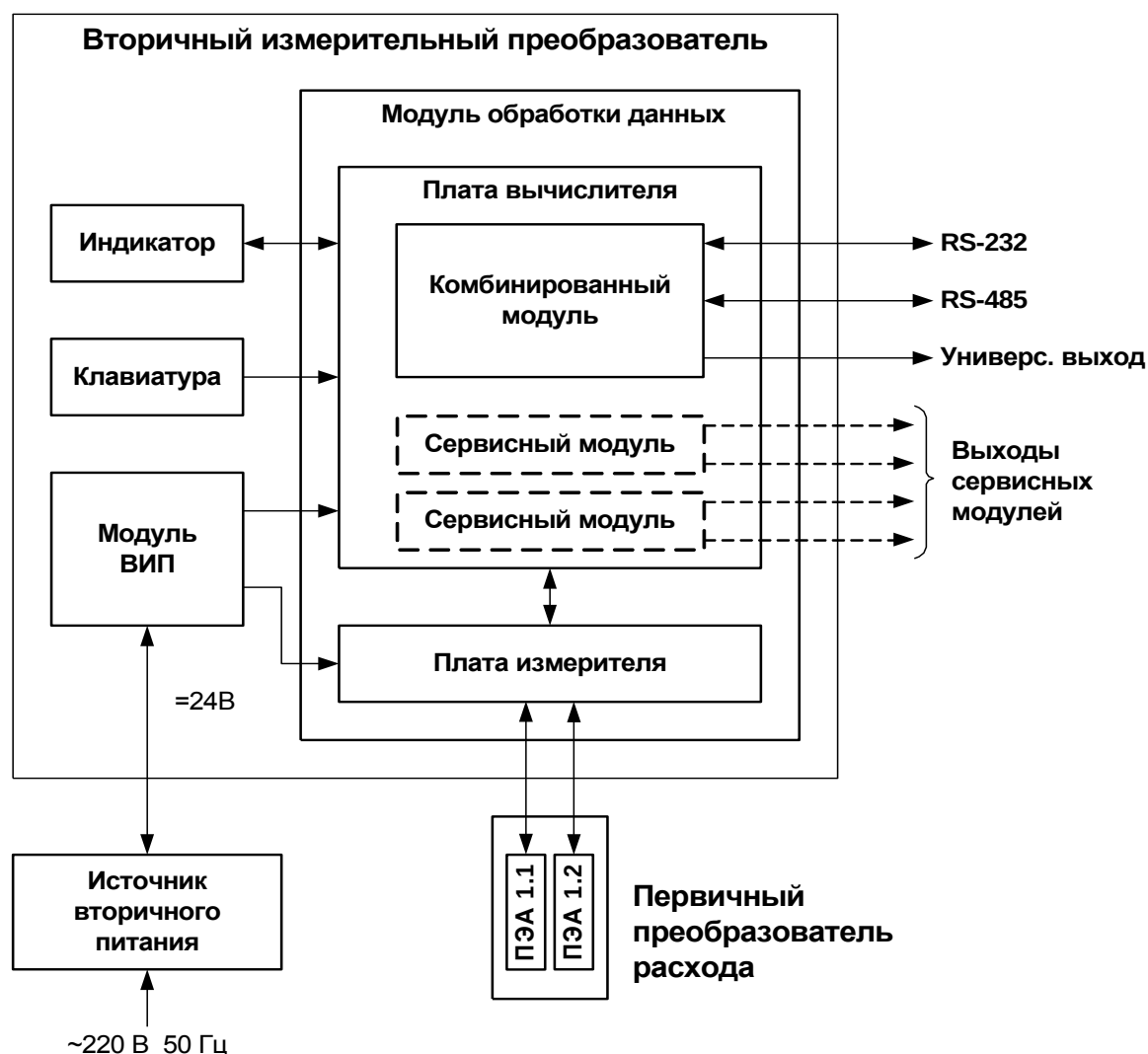
Рис. 3. Структурная схема расходомера.
