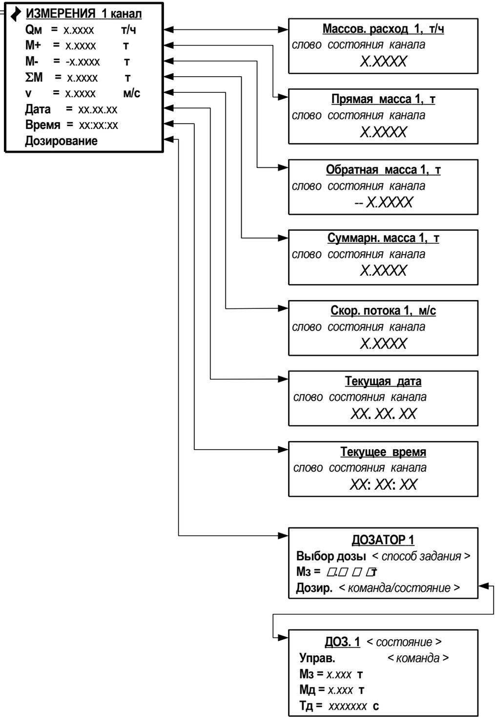
Рис. А.26. Меню «Измерения» при определении массовых параметров.
