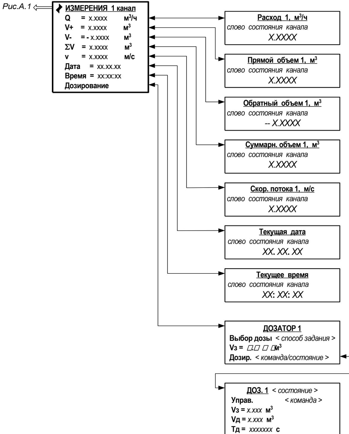
Рис. А.2а. Меню «Измерения» при определении объемных параметров.
