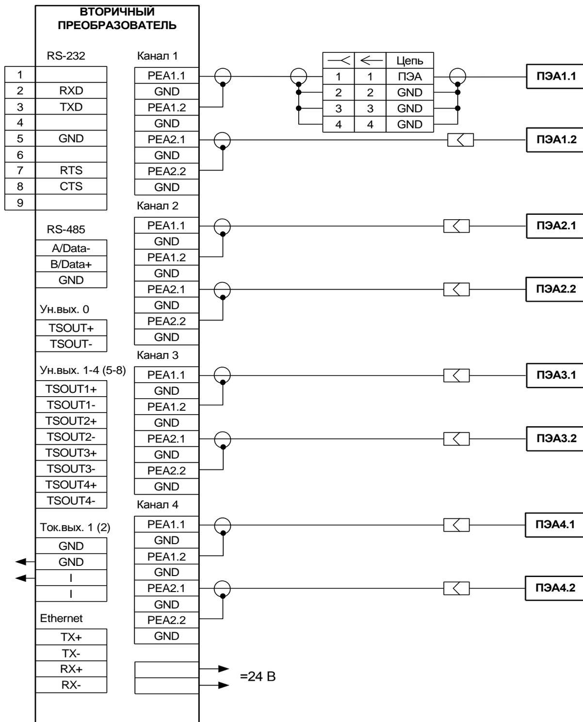
Рис.Б.1. Схема соединений расходомеров исполнения УРСВ-54х ц.
