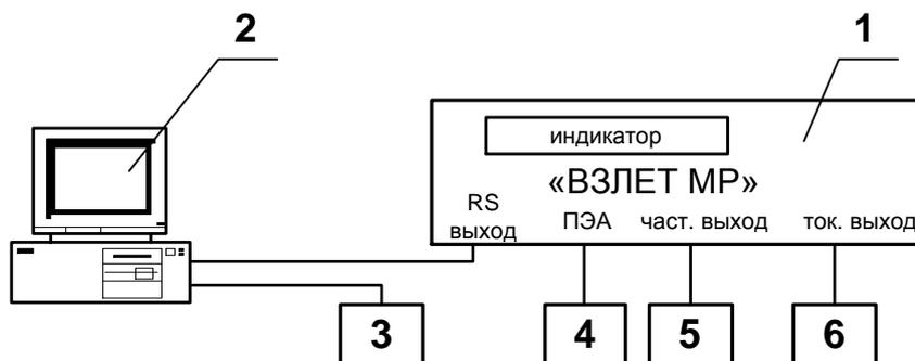
1 – вторичный преобразователь поверяемого расходомера; 2 – персональный компьютер; 3 – комплекс поверочный «ВЗЛЕТ КПИ»; 4 – акустический стенд с установленными ПЭА; 5 – частотомер; 6 – миллиамперметр.
